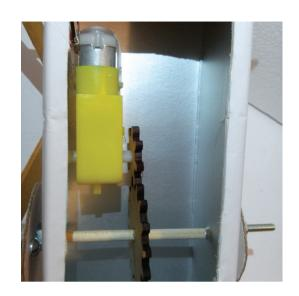
10 Pasa los cables del motor por la boquilla del envase y pega el motor del lado de la goma a la cara trasera del interior del envase asegurándote de que los engranes se acoplen perfectamente. Por último, suelda los cables que vienen del motor con los cables del broche de pila.
